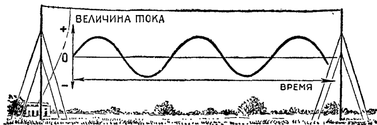
Рис. 14. Так графически изображаются колебания тока в антенне.
