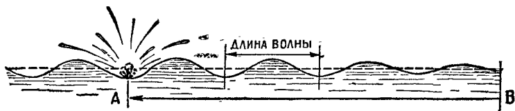
Рис. 15. Волнение от брошенного в воду камня расходитя по поверхности в виде волн. AB — расстояние, на которое распространилось волнение за секунду. Разделив это расстояние на число волн (в данном случае четыре), найдём длину одной волны.
